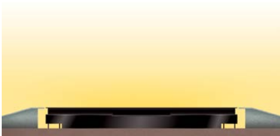
Instalação sobre piso com até 2 rampas de acesso.
